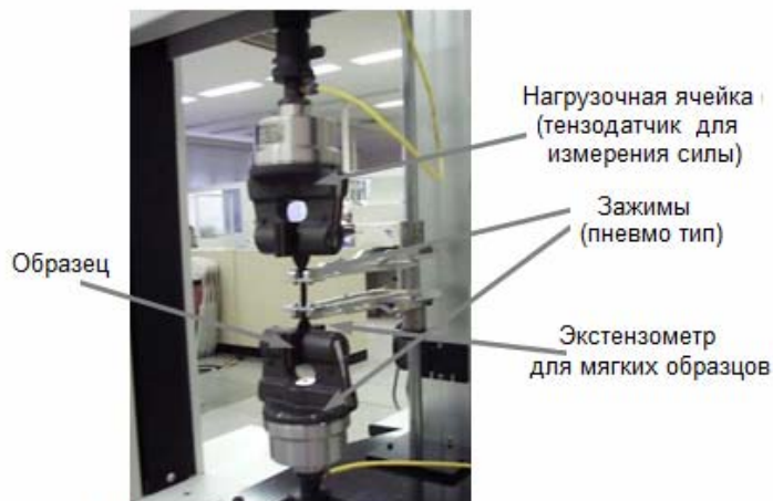
Рис.2. Испытание на растяжение тонкой пленки
