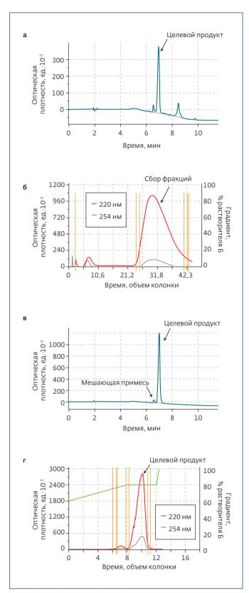
Рис.18. Хроматограмма смеси (а), первый этап разделения, нормально-фазовая хроматография (б), ВЭЖХ-хроматограмма собранной фракции (в), второй этап разделения методом обращенно-фазовой хроматографии (г)
