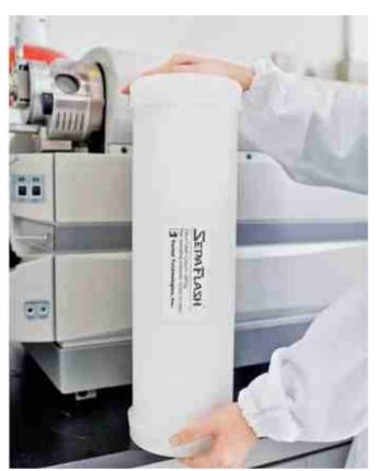
Рис.10. 3-килограммовая флэш-колонка SepaFlash
