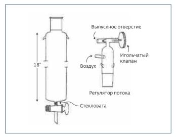
Рис.1. Первая система флэш-хроматографии из работы **У.К.Стилла** [1]
