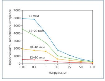
Рис.2. Эффективность разделения на обращенно-фазовых колонках в зависимости от величины нагрузки [5]
