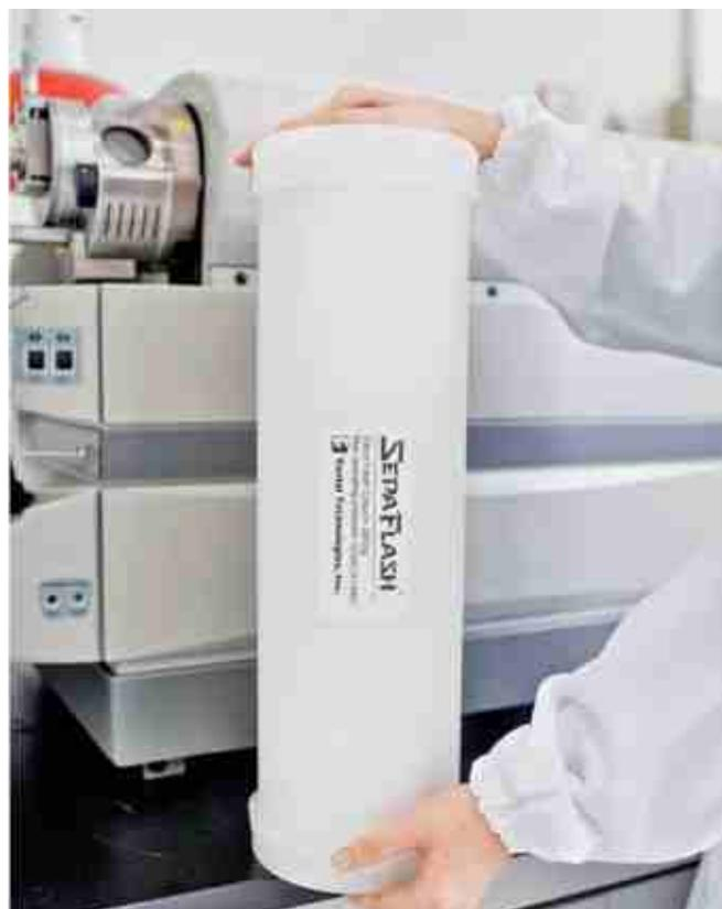
Рис.10. 3-килограммовая флэш-колонка SepaFlash
