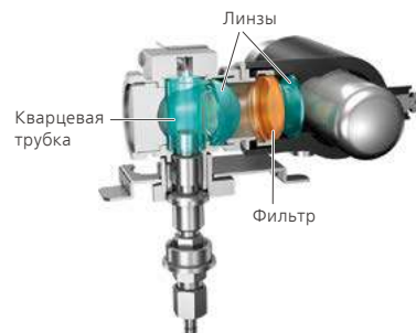
Пламенно-фотометрический детектор (FPD-2030)
