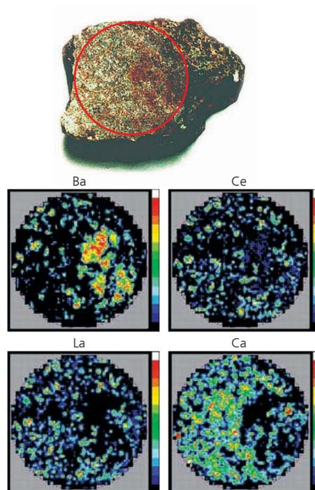
Образец представляет собой руду редкоземельных металлов Бастназит. Красным кругом отмечен анализируемый участок диаметром 30 мм с картированием. La и Ce имеют одинаковую концентрацию, а Ba и Ca распределены по образцу неравномерно; это означает, что образец содержит по крайней мере три разных минерала.
