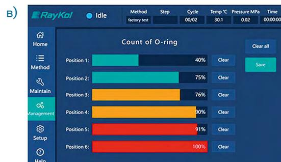
**Рис. 1.** а) система жидкостной экстракции при повышенном давлении *HPFE 06s*; б) модуль нагрева *RayKol HPFE 06s*; в) индикация ресурса уплотнительных колец экстракционных ячеек
