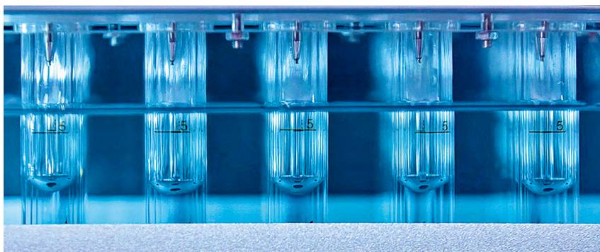
**Рис. 6.** Автоматизированная система упаривания в токе азота *EVA 80*
