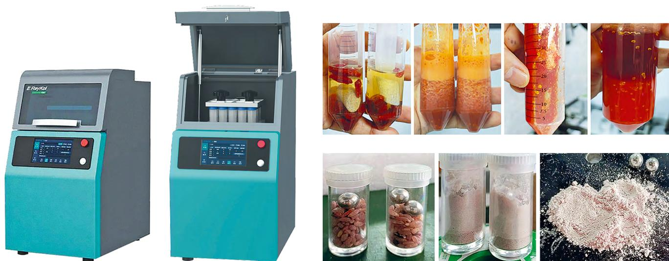
**Рис. 8.** Автоматизированный вертикальный осциллятор/гомогенизатор V20 (слева); гомогенизация ягод дерезы обыкновенной (*Lycium barbarum*) и измельчение не очищенного от отрубевой оболочки зерна риса (*Oryza sativa*) (справа)
