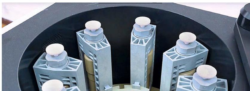
Рис. 10. Слева — ротор с высокопроизводительными сосудами (давление до 4МПа); справа — ротор с сосудами высокого давления (до 6 МПа)
