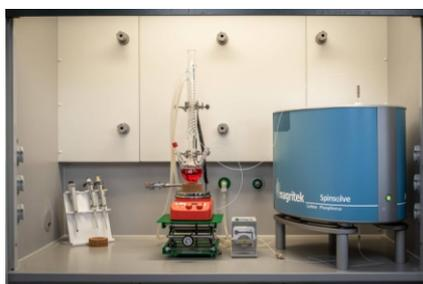
ЯМР-спектрометр Spinsolve можно легко установить в вытяжном шкафу лаборатории для оценки протекания химических реакций в режиме онлайн.
