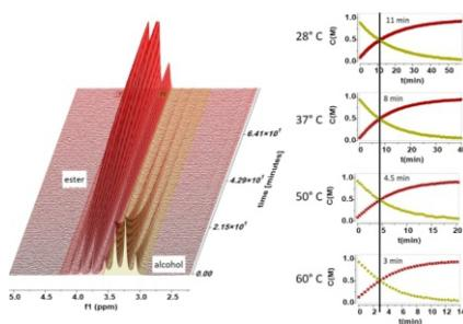
Системы Spinsolve 43 МГц могут быть оснащены уникальной системой контроля температуры, которая позволяет контролировать температуру без необходимости дополнительной подачи азота или сухого воздуха.
