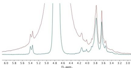
Ультра-высокая однородность поля этой версии позволяет получить самое высокое в классе настольных ЯМР-спектрометров разрешение. Конструкция прибора обеспечивает возможность наиболее эффективного подавления сигналов протонных растворителей, что особенно полезно при анализе субмиллимолярных концентраций определяемых соединений. Помимо рутинной работы в протонных растворителях, данная функция представляет интерес для таких областей как:
