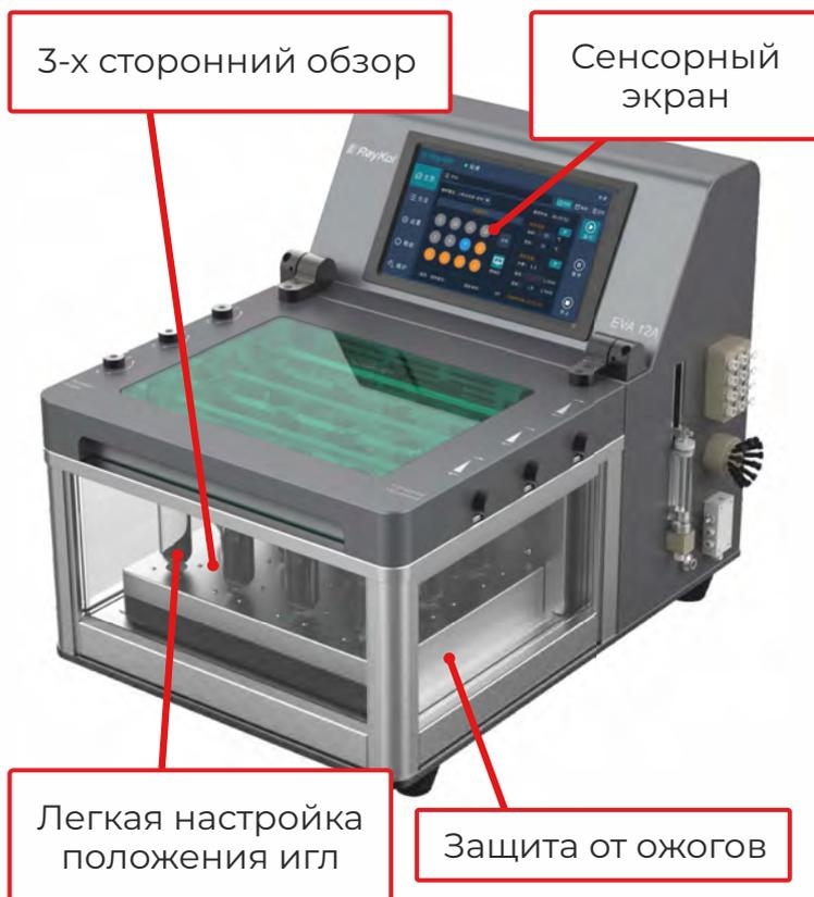
Автоматизированная система упаривания в токе азота Auto EVA 12 от Компании RayKol позволяет проводить упаривание до 12-ти образцов из пробирок объёмом до 260 мл одновременно. Для эффективности упаривания в системе используются равномерный нагрев на водяной бане, перемешивание образцов и технология вихревого потока азота. Автоматическое определение конечной точки с помощью встроенного датчика обеспечивает концентрирование до заданного Вами объема (0,5-1,0 мл).
