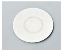
Проведите измерение образца, прикапанного и высушенного на специальной фильтровальной бумаге
