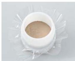
Закрепите на дне кюветы пленку и насыпьте образец (метод свободной засыпки)
