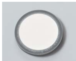
Спрессуйте порошок в таблетку с помощью пресса (метод прессования)
