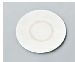
Проведите измерение образца, приканного и высушенного на специальной фильтровальной бумаге
