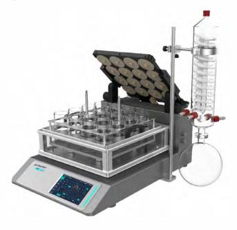
В пробоподготовке, особенно в лабораториях контроля окружающей среды, безопасности пищевых продуктов, ветеринарных лабораториях, в фармацевтической и биохимической отраслях промышленности, - для получения точных и надежных результатов определения следовых количеств компонентов, применяется быстрое концентрирование методом испарения в вакууме.
