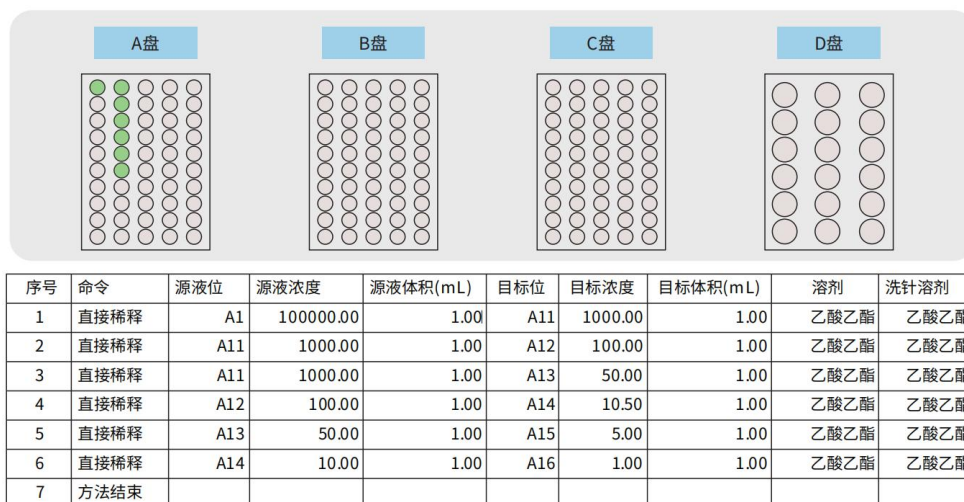
Рис.-1. Процедура дозирования жидкости Auto Prep 200.
