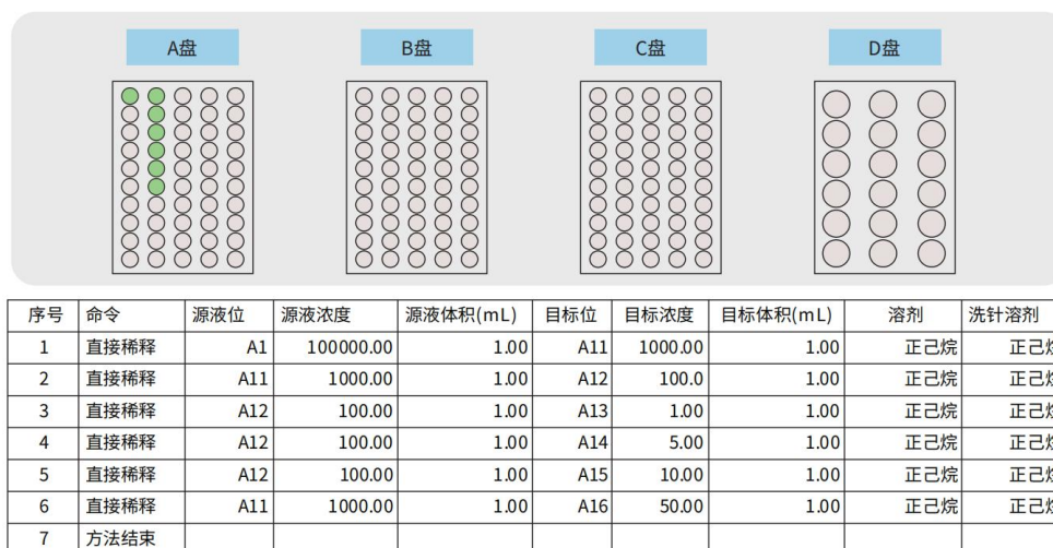
Рисунок-1. Процедура приготовления растворов с помощью Auto Prep 200.
