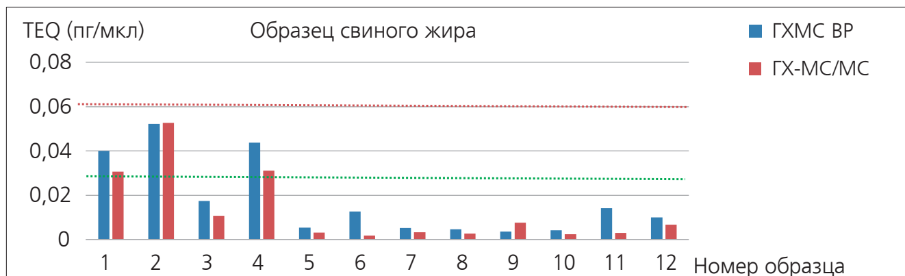
Сравнение результатов определения диоксинов в образцах свиного жира, полученных методами GXMS BP и GX-MS/MS
