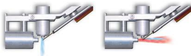
Рис. 1 Режимы работы модулятора: охлаждение (слева), нагрев петли (справа).
