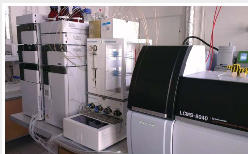
Рис. 3 Пример сопряжения онлайн-системы твердофазной экстракции ACE™ + HPD™. Spark Holland с тройным квадрупольным жидкостным хроматомасс-спектрометром LCMS-8040 Shimadzu
